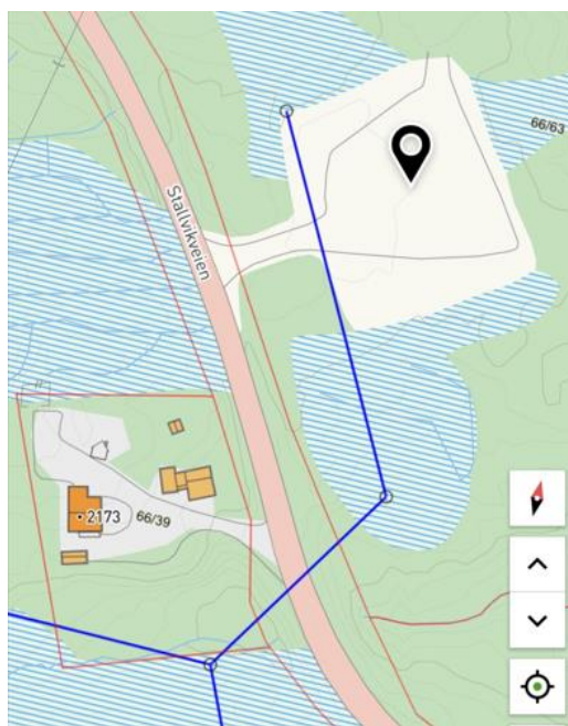
Fig. 13 Vannledning til området
