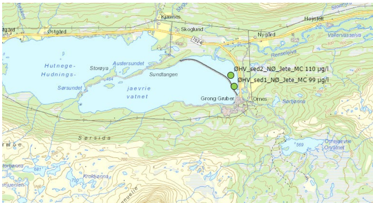
Figur 4-22: Analyseresultater øst for sjete med tilhørende tilstandsklasser for sink i sedimentprøver hentet i september 2020.
